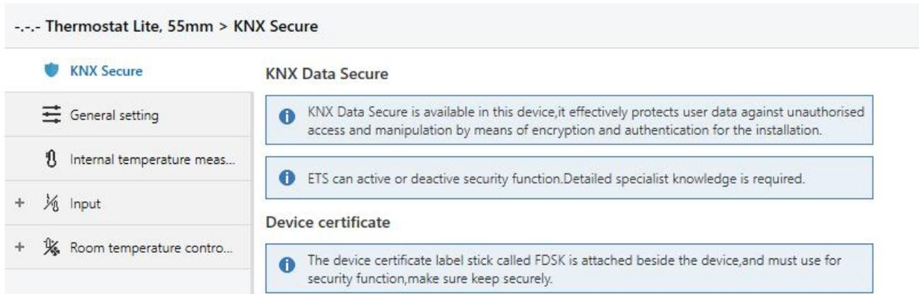
图 5.1 (1) “KNX Secure” 参数界面
